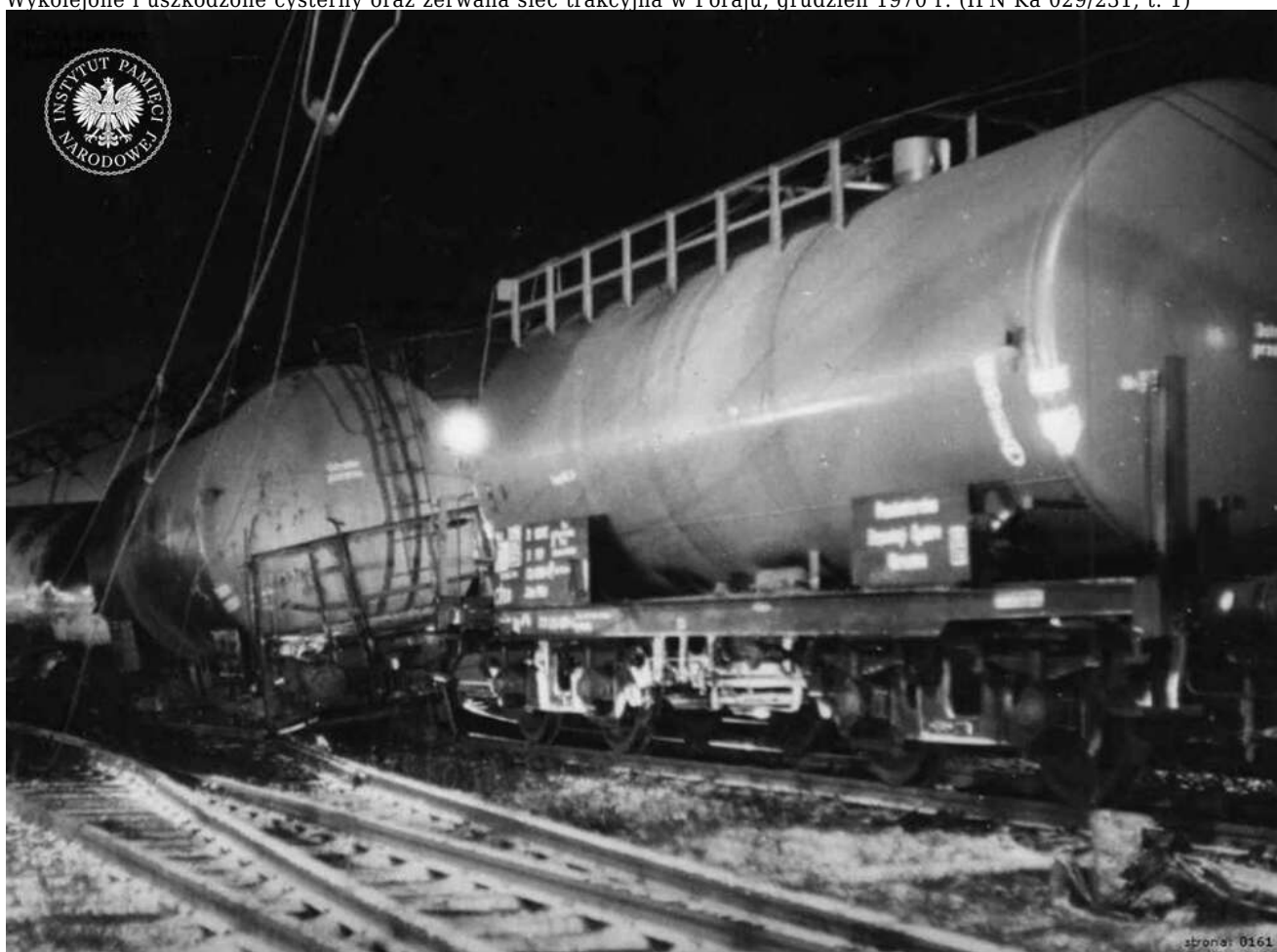
Wykolejone i uszkodzone cysterny oraz zerwana sieć trakcyjna w Poraju, grudzień 1970 r. (IPN Ka 029/231, t. 1)
